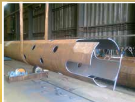
Meerpalen : stalen buizen Ø1067 x 14 mm, staalkwaliteit X60, lengte 14 m, 132 ton _Ducs d'Albe : Tubes acier Ø1067 x 14 mm, qualité d'acier X60, longueur 14 m, 132 tonnes
